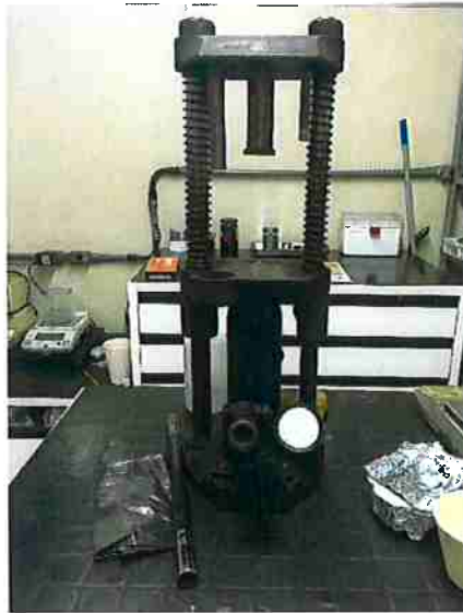
Figura 16 - Prensa utilizada para a fabricação dos briquetes
