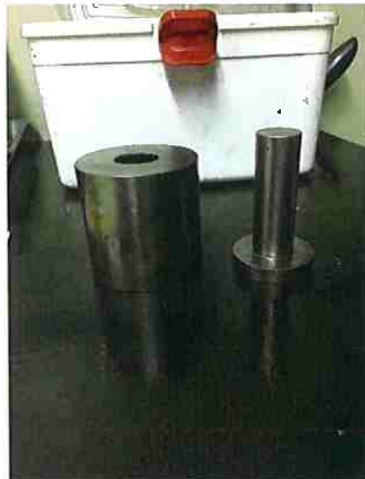
Figura 17 – Matriz cilíndrica com 25 mm de diâmetro
