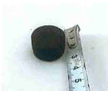
Figura 22 - Briquete com arroz cru (20% de amido) após o tratamento térmico
