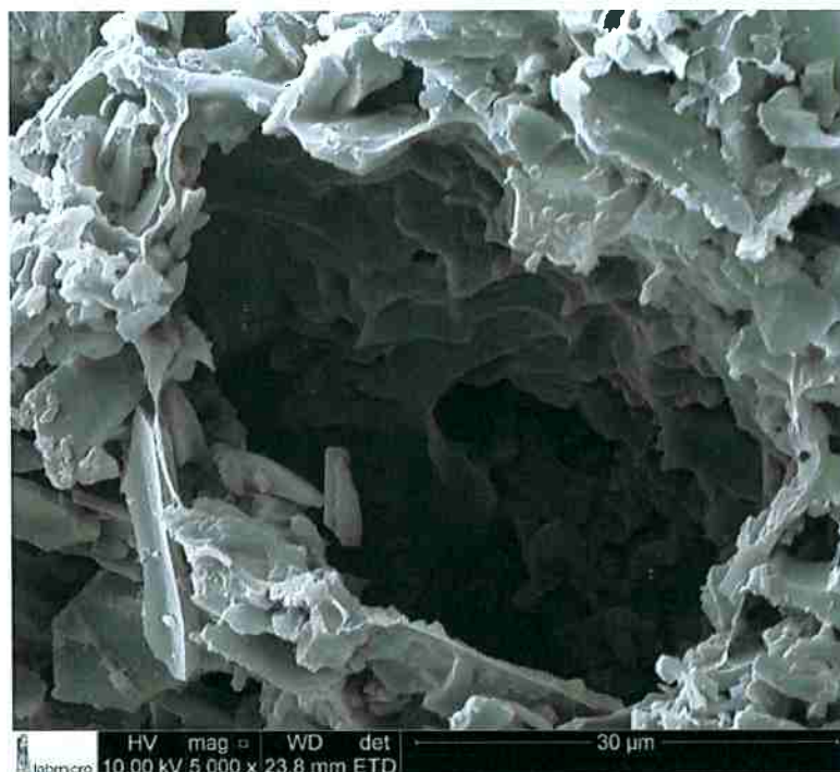
Figura 34 – Amostra 4 – arroz cozido, 20% de amido, Moagem de alta energia
